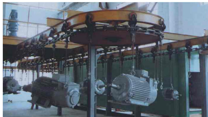
▶ 装配喷漆流水线
